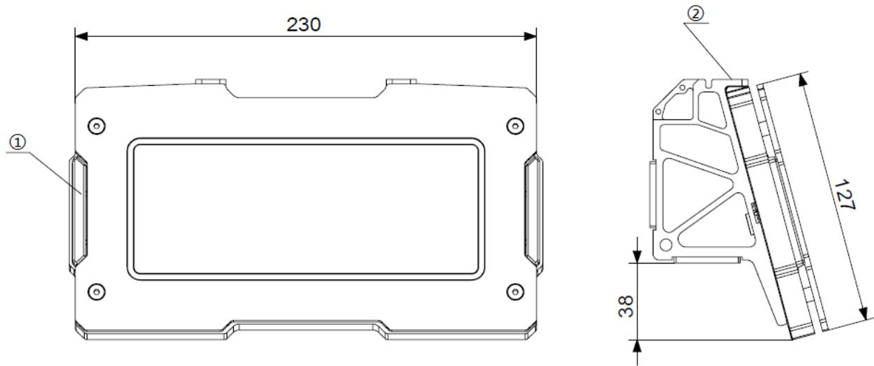
[1] 侧灯 [2] 顶部用竖直 M4 螺钉固定
