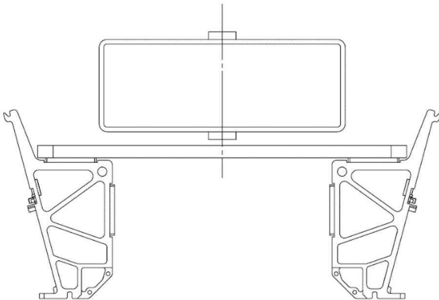
图 3-23 哨兵支撑架安装示意图
