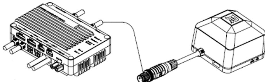
图 3-44 定位模块连线示意图
