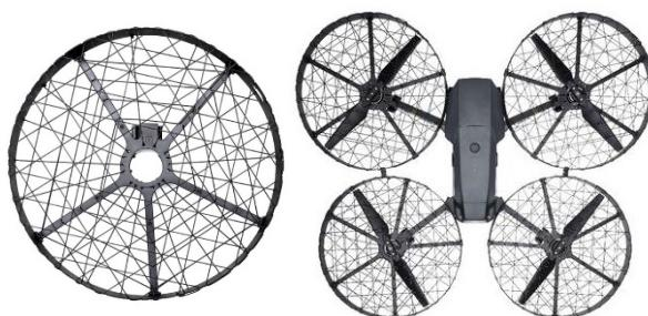
S42 全封闭桨叶保护罩受 2 m 距离外速度为 12 m/s 的 42 mm 弹丸射击后，保护罩任意部分不可产生接触桨叶的形变，影响桨叶的正常转动，且该 42 mm 弹丸不可穿过保护罩网孔，建议保护罩最大网孔面积不大于  $9 \text{ cm}^2$ 。
