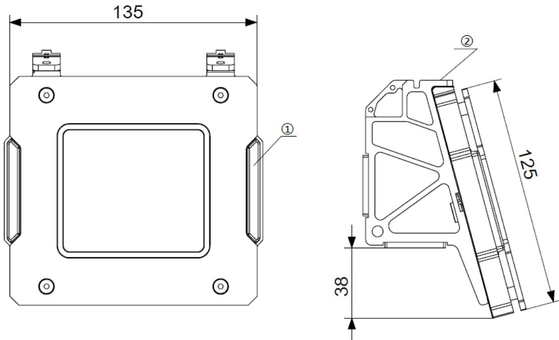
[1] 侧灯 [2] 顶部用竖直 M4 螺钉固定
