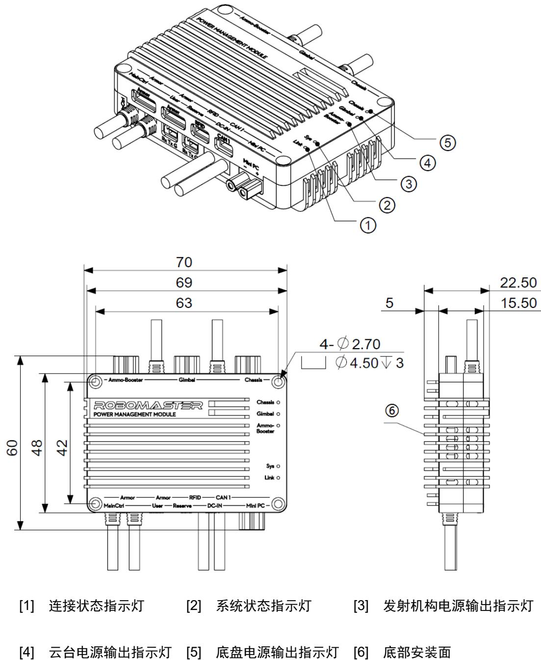
[1] 连接状态指示灯 [2] 系统状态指示灯 [3] 发射机构电源输出指示灯
