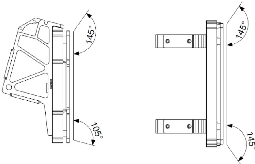
**S93** 工程机器人的所有装甲模块受攻击面下边缘  $105^\circ$  内不得被遮挡。所有的装甲模块下方的机器人外边缘与装甲模块下边缘的垂直距离小于  $100\text{mm}$ 。四块装甲模块中至少三块装甲模块满足上、左、右边缘  $145^\circ$  内不被遮挡，允许有至多一块装甲模块可以在受攻击面上、左、右边缘的  $145^\circ$  内发生有条件遮挡，遮挡条件为：在该装甲模块受攻击面所在的平面上，距离装甲模块的上边缘大于  $215\text{mm}$ ，或距离左、右边缘大于  $170\text{mm}$  可以发生遮挡，即下图阴影部分不可被遮挡。
