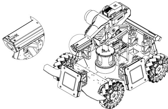
图 3-29 测速模块安装示意图
