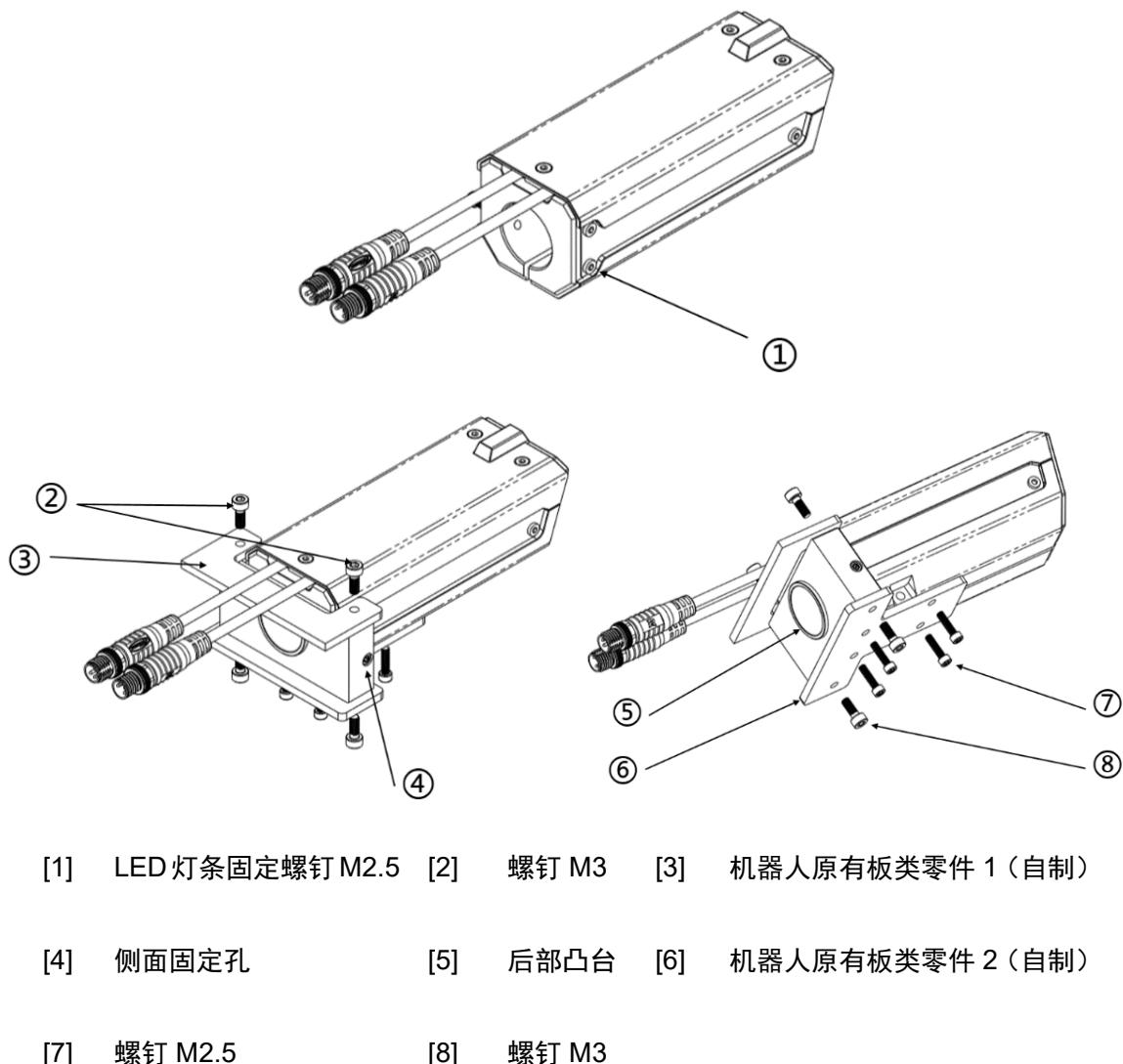
图 3-31 17mm 转接块固定方式示意图
